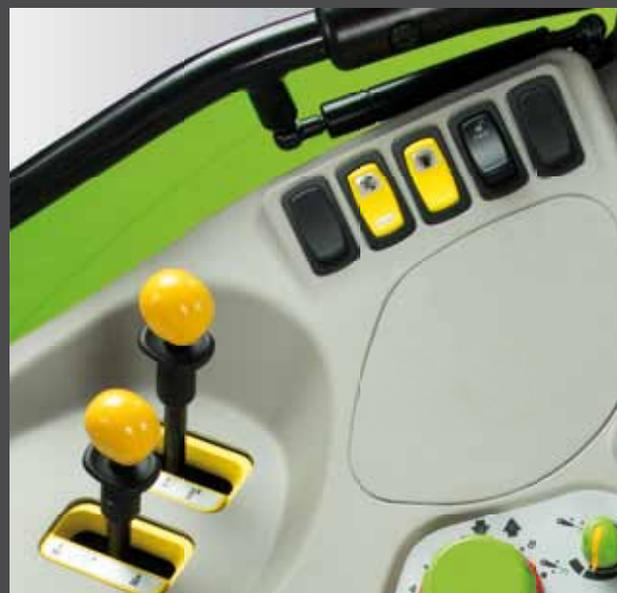
Hebel zur Auswahl der Zapfwellendrehzahl mit Zu- und Abschaltung durch komfortable, elektrohydraulische Bedienelemente.
